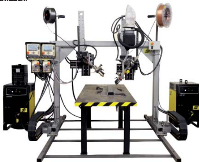
Mechtrac equipaggiato con teste A2, PEK e generatore LAF 631
